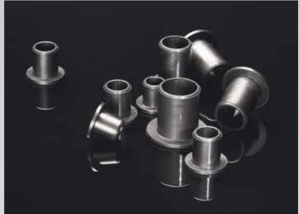
Abb. 2: Lager für die medizinische Industrie in STAR-THERM® E A 2C TSO: Hier ist neben elektrischer Leitfähigkeit auch gutes tribologisches Verhalten gefragt.
